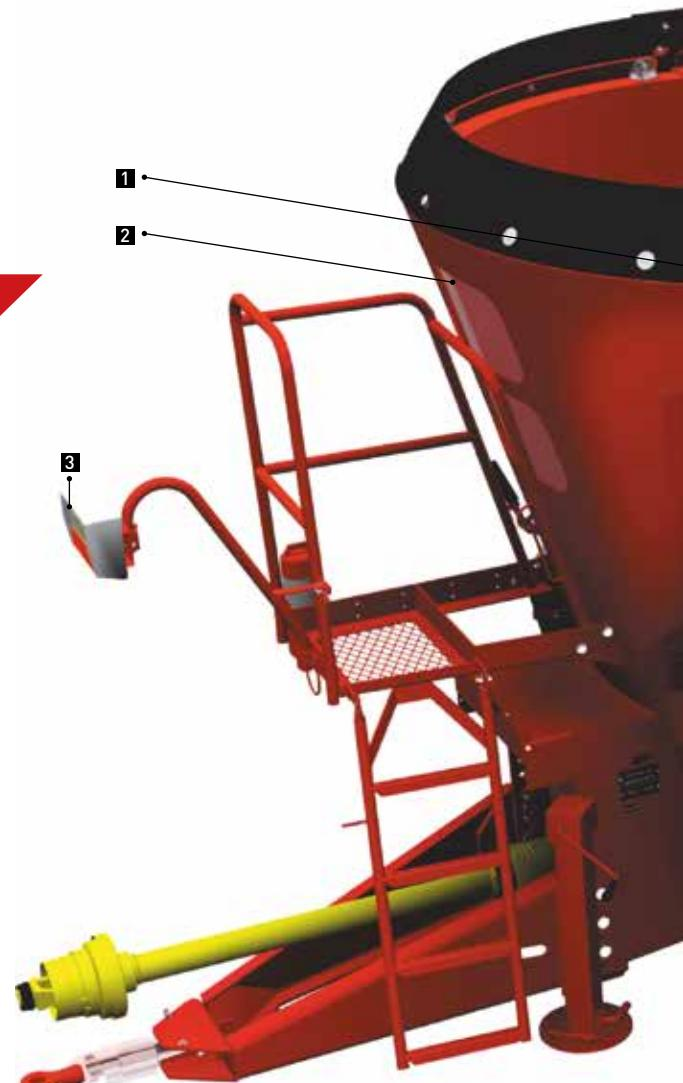
**1 Horizontal Flow med forskyvningsinnsatser** | Trioliet fullfôrvogner er utstyrt med patenterte forskyvningsinnsatser for interaksjon mellom fremre og bakre blandekammere (tvungen horisontal blanding), noe som gir rask og homogen blanding og en jevn og fullstendig utmating.
