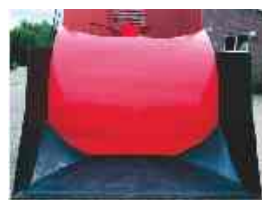
Solide konstruierte Ladeklappe mit breitem Verschleißstreifen und hohen Seitenwänden. Die Rundungen in den Ecken zentrieren den Block bei der Aufnahme.
