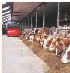
Das gemischte Futter kann wahlweise mit einem Querförderband gleichmäßig nach links oder rechts verteilt werden.
