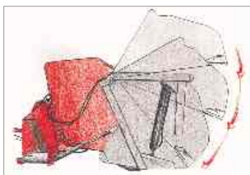
Das solide, leicht gewölbte Schneidschild mit einer maximalen Entnahmehöhe von max. 4.00 m kann in einem Arbeitsgang ca. 3.0 m 3 Silo ausschneiden. Die hydraulisch klappbare Ladeinheit befördert das Futter ohne Verluste von oben in die ovale Mischkammer.
