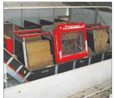
Quer- und Schrägförderkette mit elektronischer Waage.
