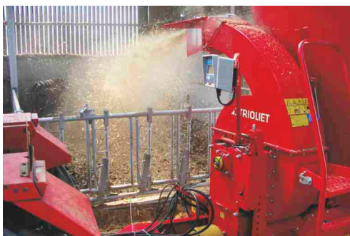
Wurfweite Strohgebläse: 15 bis 18 m.
