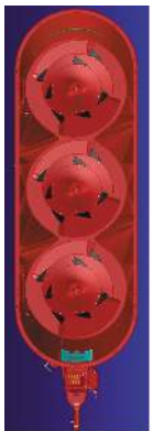
Drei planitair angetriebene Vertikalschnecken und Horizontalflußsystem.
