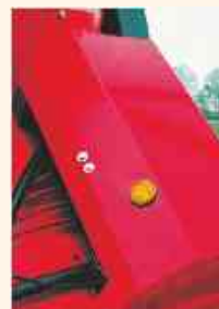
Eine gut sichtbare Kontrolleuchte an der Vorderseite des Triomix S zeigt dem Fahrer wann das Schneidschild bis auf die Ladeklappe runtergeschnitten hat.
