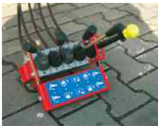
Mechanische Fernbedienung über Bowdenzüge ist auf Wunsch lieferbar.
