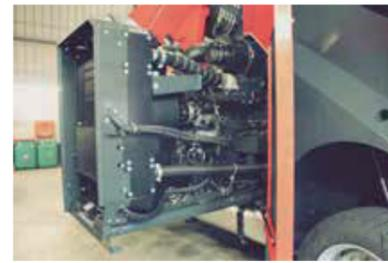
Gut erreichbarer Dieselmotor | dank hydraulisch ausfahrbarem Schlitten
