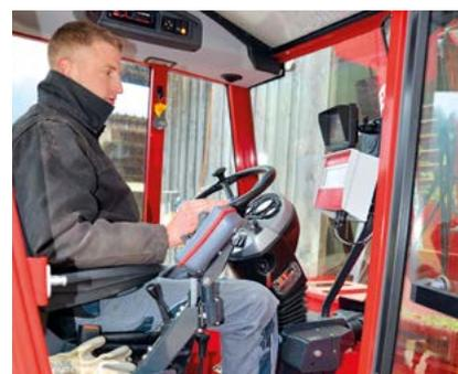
Der Fahrersitz und die Bedienung können um 180 Grad gedreht werden.
